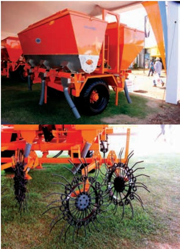
*Outros dois implementos de destaque da DMB, a distribuidora de calcário em linha e a instalação de desenheiradores atrás da adubadeira, nutrem o solo e retiram a palha de cima da soca, eliminando a morada da cigarrinha*
