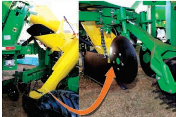
*Devido a uma nova forma de distribuição dos toletes, através de um tobogã, a máquina não precisa das rodas deitadoras*
