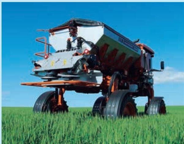
Na categoria Agricultura de Escala, a ganhadora foi a empresa Jacto com a adubadora automotriz Uniport 5030 NPK. O equipamento possui reservatório de 5.000 kg de capacidade e faixa de aplicação de até 50 metros para fertilizantes granulados e 12 metros para produtos em pó.
