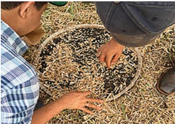
*Figura 5. Armação circular posicionada para coleta de perdas*
