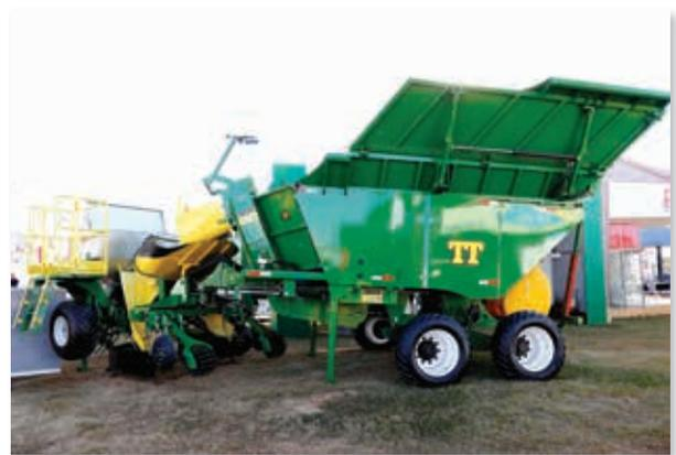
*O que chama mais atenção na máquina é que ela é dividida em duas partes, a primeira que é anexada aos três pontos do trator e a segunda com a caçamba de mudas*
