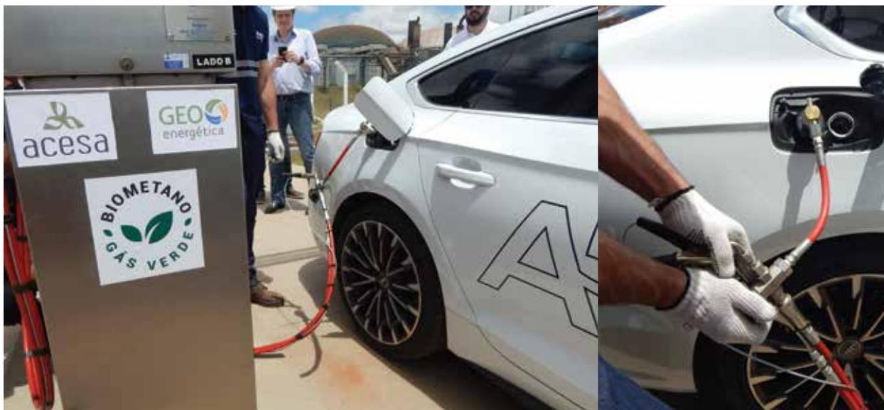
*O Audi A5 g-tron sendo abastecido com biometano produzido pela Acesa Bioenergia e ao lado, em destaque, o bocal de abastecimento com entradas individuais para gás natural e gasolina*
