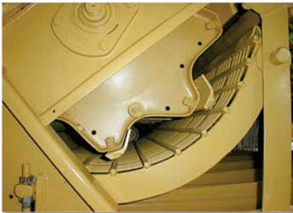
**Figura 1 – Sistema de trilha radial composto por cilindro e côncavo**
