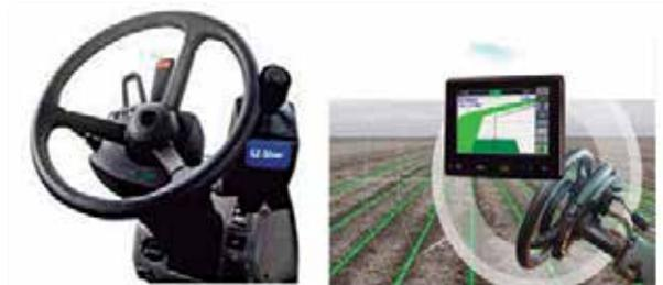
É constituído por um motor elétrico fixado na coluna de direção por meio de um suporte universal. Esse suporte permite que sejam feitos ajustes, de modo que a extremidade do motor fique em contato com o volante, movimentando-o para que o trator siga o alinhamento determinado. Desta forma, o eixo do motor elétrico gira nos dois sentidos, fazendo com que o volante da máquina vire para a direita ou para a esquerda.
