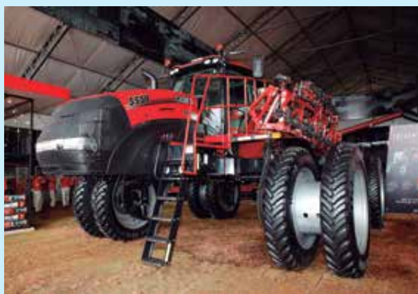
O Trident, da Case, traz as rodas dupladas como recurso para a redução da compactação do solo
