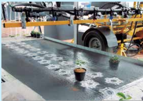
Sistema Claudia usa a Inteligência Artificial para aplicar o produto somente nas plantas invasoras
