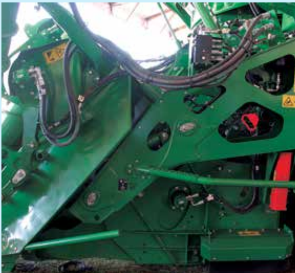
Ao contrário da colhedora de linha simples, todo o seu sistema de leitura do relevo fica no cabeçote, independente do restante da máquina, o que leva a um consumo menor de diesel
