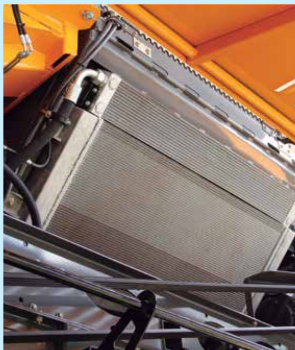
A Valtra traz a tecnologia de radiadores em V, que possui um sistema de limpeza automática realizada a cada 15 minutos
