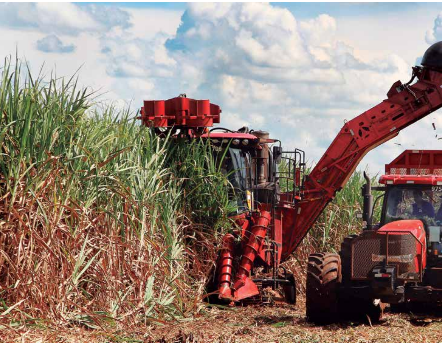
Colhedora trabalhando com o sistema de corte de ponteira desligado - detalhe simples que o produtor precisa estar de olho para não ficar sem a bonificação referente à premiação pela qualidade
