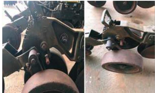
**7 - Rodas compactadoras:** Na abertura e fechamento do sulco de semeadura pode haver a formação de bolsões de ar. A redução desses bolsões favorece os ambientes térmico e hídrico e o acondicionamento físico do solo ao redor das sementes.
