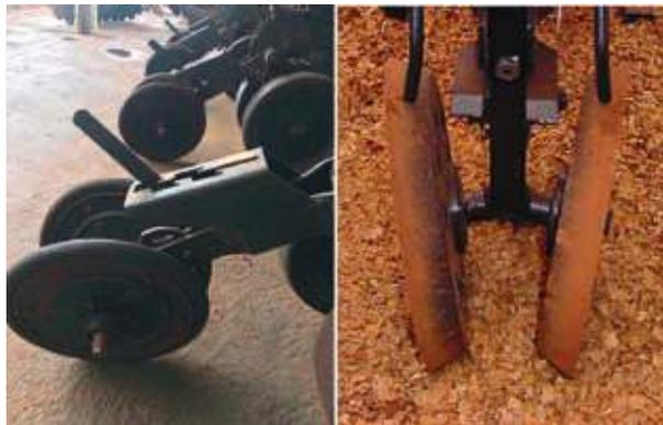
**8 - Roda de tração:** Os dosadores são movidos através de um sistema de engrenagens (movida e motora), e estes são acionados por meio da roda de tração ou motriz (em grande parte do número de semeadoras a campo). Assim, semeadoras com esse sistema não dependem da velocidade de trabalho e sim do número de voltas da roda motriz.
