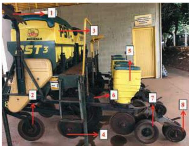
**1 - Marcador de linha:** Permite facilitar o serviço de semeadura mantendo-se o espaçamento pré-definido entre as sucessivas passadas da máquina na área, evitando-se a sobreposição ou afastamento das passadas. É calculado com o auxílio da seguinte equação:
