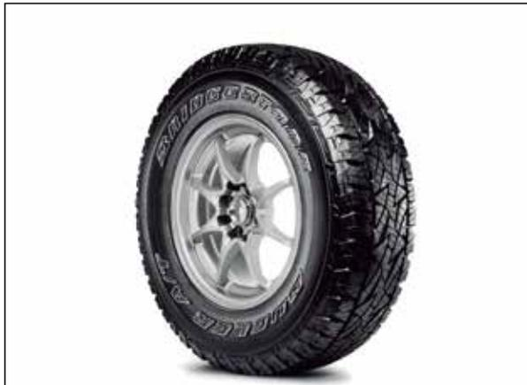
*Pneu da Bridgestone Dueler Revo 2, com tecnologia para uso tanto em asfalto como na terra. Seu desenho, com sulcos longitudinais no centro, transversais no ombro e blocos desenhados em V, garantem segurança tanto em condições de aquaplanagem como em atoleiro*
