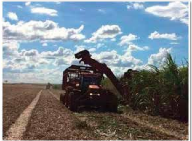
Piloto Automático em canteiro de 2,8m – Colheita de 2 linhas de 1,5m (Usina Cerradinho)
