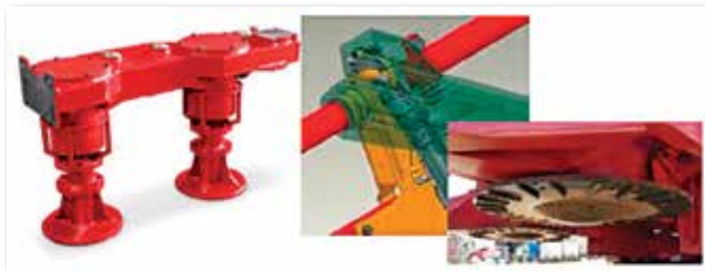
Sistemas de Automação do Corte de Base (Auto Tracker – 1 linha; AutoFloat – 2 linhas)
