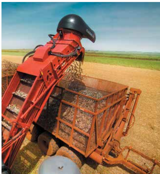
Elevador com velocidade variável da esteira – maior vida útil para o material de desgaste
