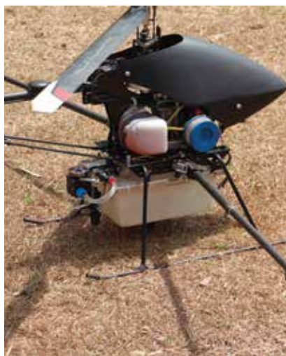
Drone que é capaz de fazer a aplicação de herbicida de forma localizada
