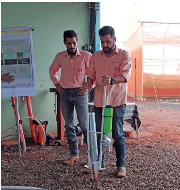
*Protótipo da nova matraca para o plantio de MPB utilizando o UPDT*
