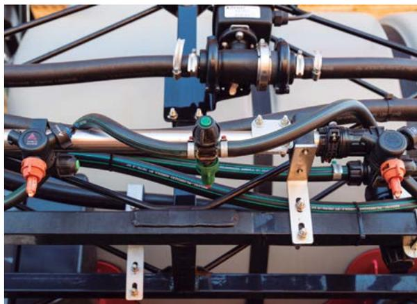
*Barra do autopropelido adaptada para a aplicação de dois tipos de herbicidas: um em área total (bicos laranjas) para combater folhas estreitas e o outro (bico verde) que solta o defensivo de maneira precisa, somente onde há folhas largas*
