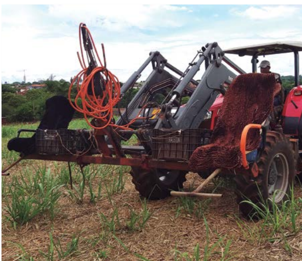
Catção química executada através de um implemento criado na própria fazenda por Mateus, capaz de trabalhar 20 alqueires por dia
