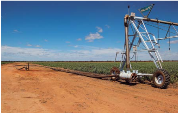
Pivô linear (anda em linha por talhões) é abastecido a cada 130 metros por hidrantes colocados no caminho
