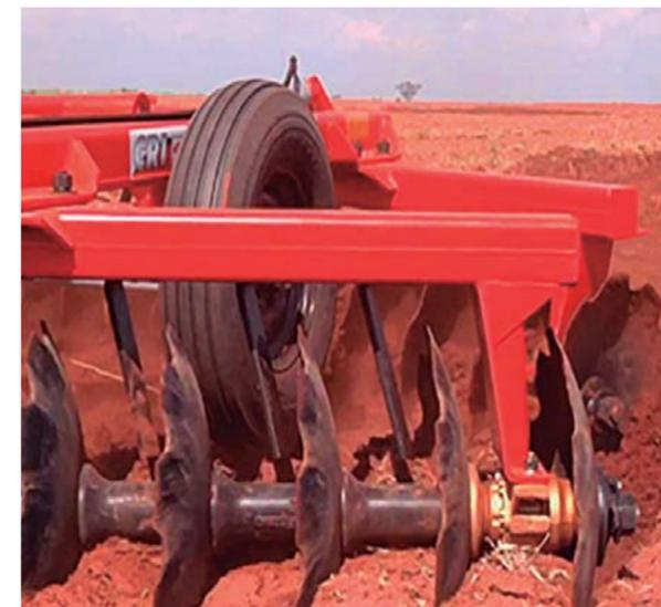
“Equipamentos destinados ao preparo do solo, visando o destorroamento e o nivelamento do terreno, para possibilitar melhores condições à sementeira”
