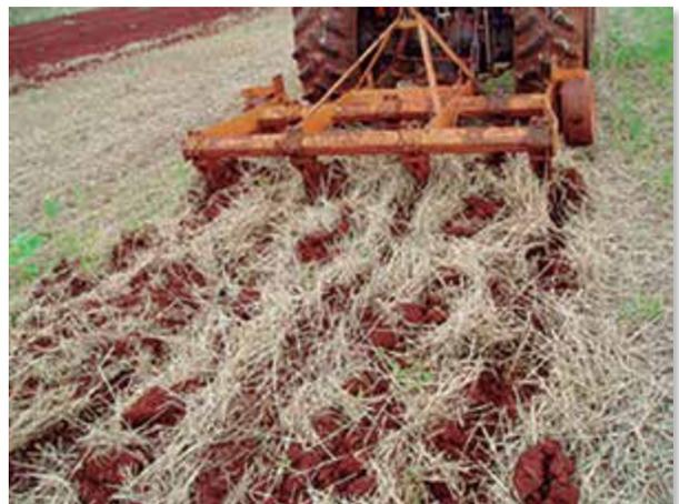
Alguns autores separam a operação da subsolagem da escarificação, por meio da profundidade de trabalho. Para profundidades entre 5 e 15 cm tem-se a escarificação leve; para valores de 15 a 35 cm, a escarificação profunda e para profundidades maiores que 35 cm, tem-se a subsolagem (podendo chegar à profundidade de até 1,0 m).
