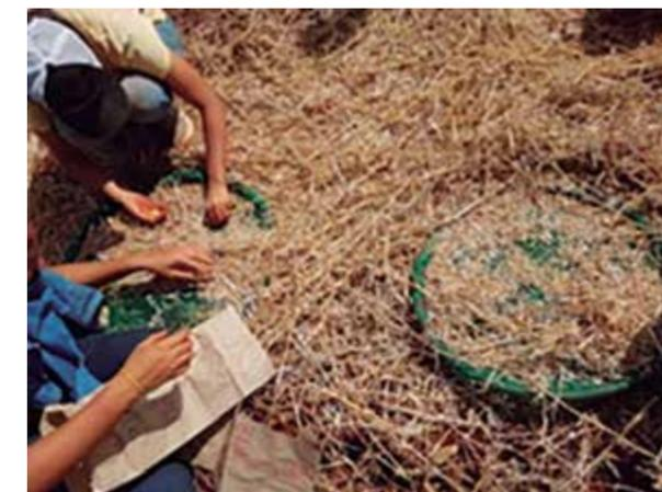
Para avaliação do experimento consideramos o retângulo formado entre os quatro rodados cobrindo todo comprimento da plataforma, e posicionamos oito aros circulares nesse espaço, divididos em duas fileiras. Uma fileira de quatro aros posicionada próxima da plataforma de corte (A), perto do triturador de palha (B).
