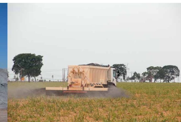
Esteira no fundo da caçamba controla a quantidade exata de corretivo que será lançado
