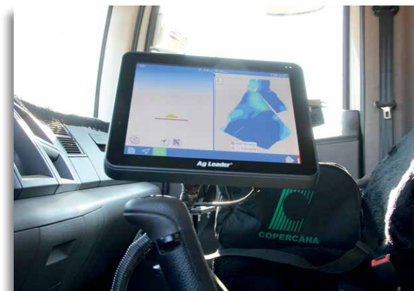
Sistema de GPS mostra para o motorista todas as informações referentes ao manejo
