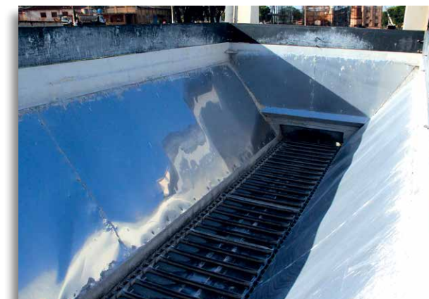
Esteira no fundo da caçamba controla a quantidade exata de corretivo que será lançado
