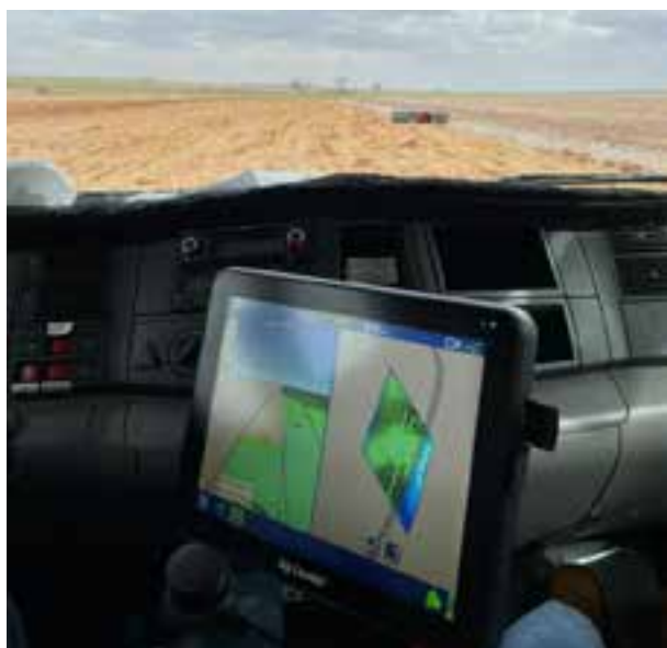
Figura 3. Monitor dentro da cabine do caminhão com o mapa de distribuição de calcário e alinhamento entre passadas do caminhão.
