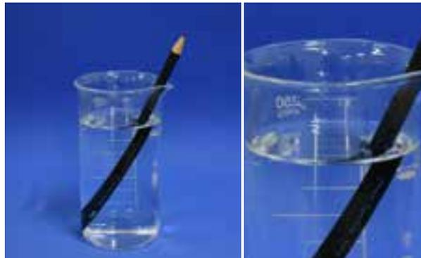
Na imagem podemos observar a diferença existente entre o meio externo e o meio interno. O exemplo do lápis na água consegue nos mostrar como a refração funciona, e como o equipamento “enxerga” os sólidos dentro do caldo. Através dessa diferenciação o refratômetro transmite o valor em porcentagem de sólidos solúveis no caldo de cana.
