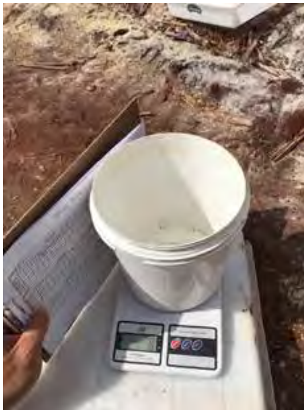
Ensaio executado pela equipe da Copercana com o objetivo de calibração da largura de trabalho ideal conforme o tipo de cada corretivo
