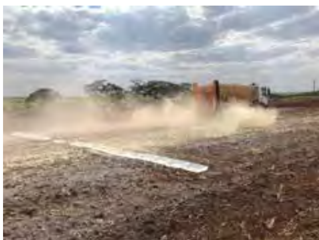
Ensaio executado pela equipe da Copercana com o objetivo de calibração da largura de trabalho ideal conforme o tipo de cada corretivo
