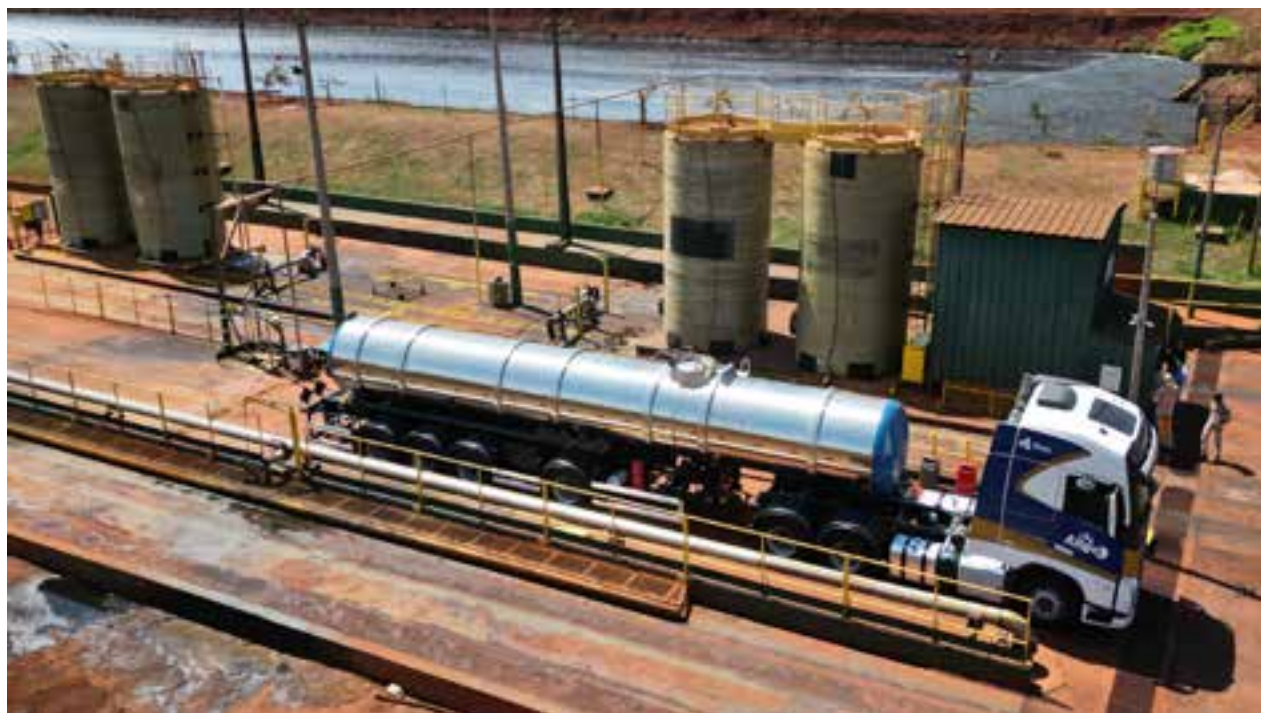
Caminhão da Fass Agro entrega adubo num ponto de abastecimento de vinhaça da Usina Alta Mogiana, logística capaz de acompanhar a velocidade da aplicação é um quesito imprescindível para o processo de fertirrigação funcionar
