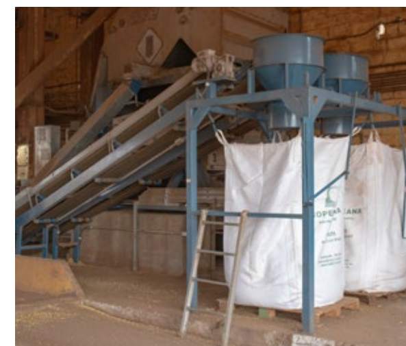
Instalação da segunda balança, impermeabilização do teto da cúpula e adequação do depósito do resíduo pré-limpeza em bags foram as três principais melhorias da unidade
