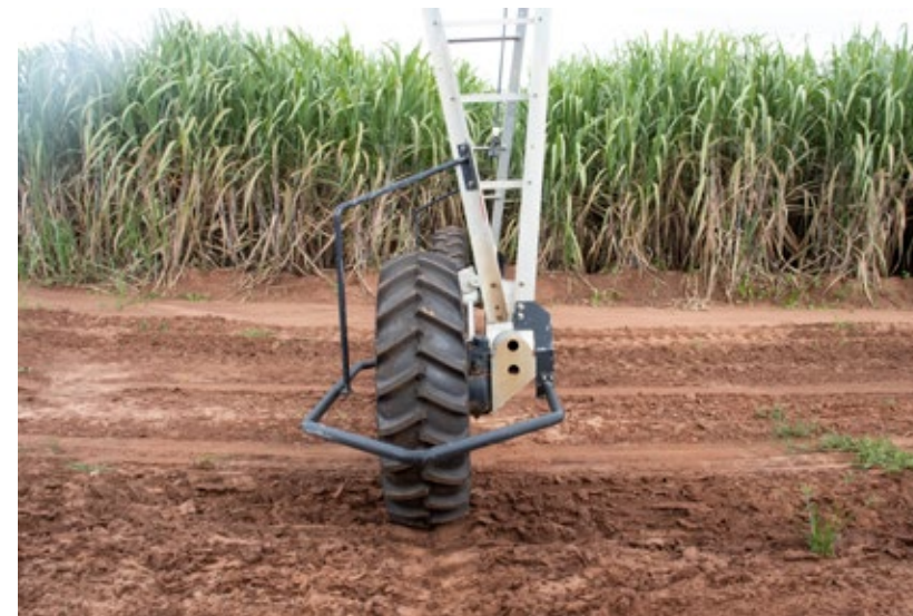
Limpa trilho colocado em volta da roda do pivô permite o seu uso ao longo de todo ciclo do canavial
